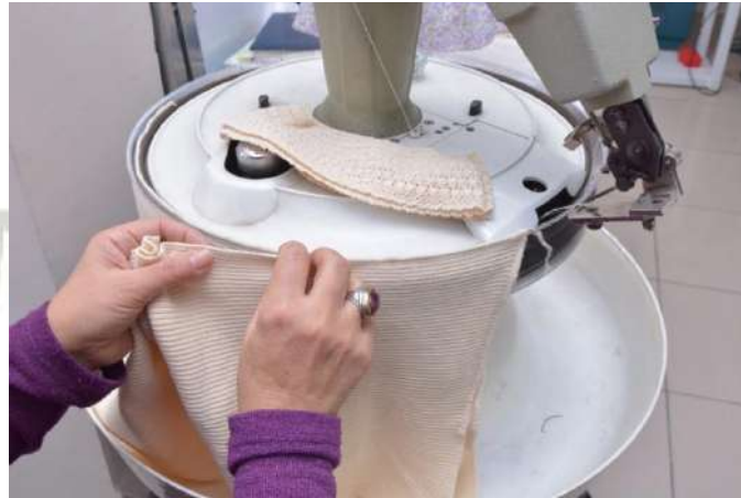
Fotoğraf 11.Remayöz Makinesinde Ön-Arka Yan Çatma (Gönül ÜNVER Fotoğraf Arşivi)
