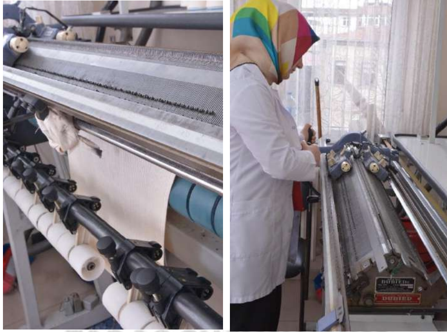
Fotoğraf 3-4. Yeni Tip Fanila Örmek Makinesi Üretimde
