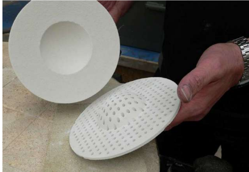
Şekil 2. Yapıştırıcıyla toz bağlama teknolojisiyle üretilmiş, seramik kâse ve destek materyali (Huson & Hoskins, 2014: 357) (05.05.2020)
